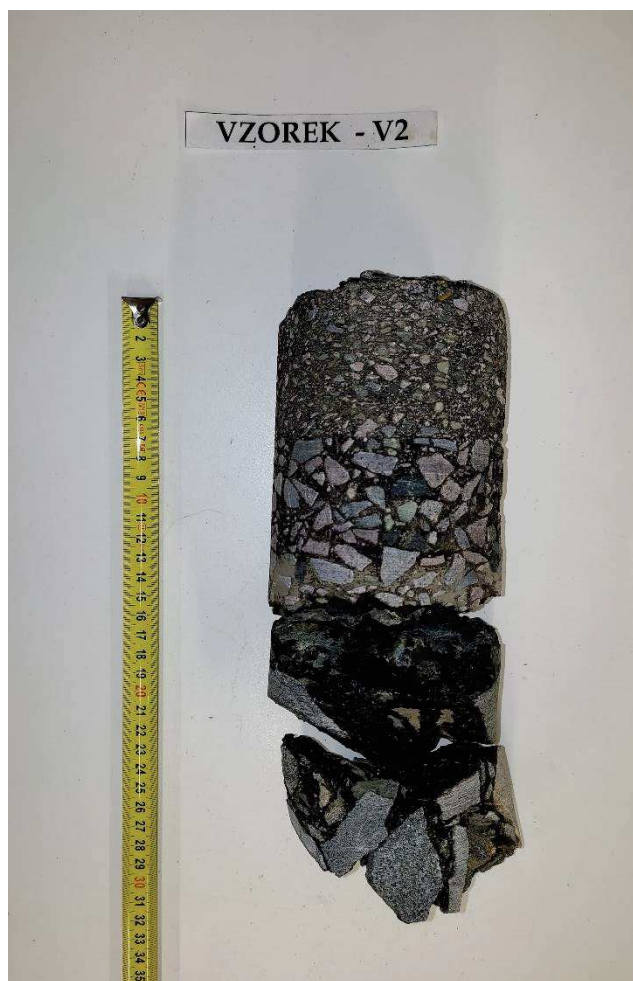
Obr. 4 - Jádru vývrtu Vzorek – V2 (laboratoř).
